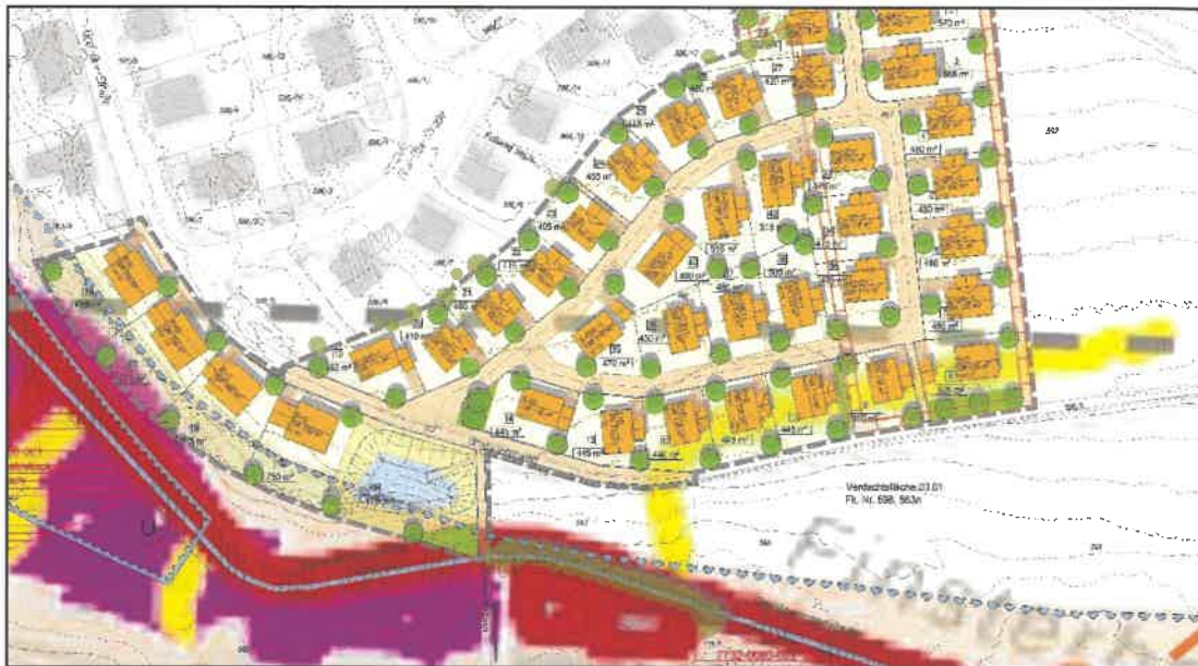
Abb. 20: Städtebaulicher Entwurf überlagert mit Hinweiskarte Oberflächenabfluss und Sturzfluten (LfU 02-2024), gelb: potentieller Fließweg bei Starkregen mit mäßigem Abfluss, rot: potentieller Fließweg bei Starkregen mit starkem Abfluss (Verlauf des Finsterbaches), magenta: Geländesenke und Aufstaubereich, hellbraun: wassersensibler Bereich, Plangrundlage: Geodatenbasis © Bayerische Vermessungsverwaltung, Originalmaßstab 1:5.000
